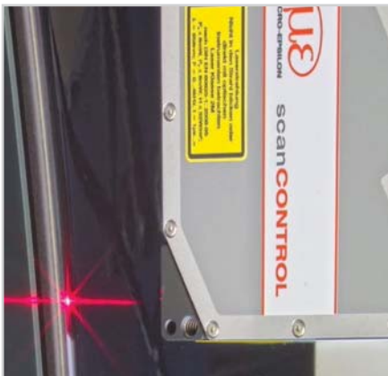
車体のギャップ測定
