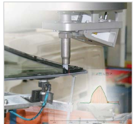
粘着ビードの塗布検査
