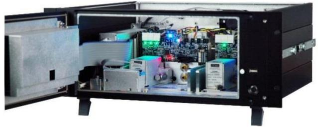
のソレノイドバルブを用いた特別な圧力調整技術によって、正確な圧力コントロールを行います。
