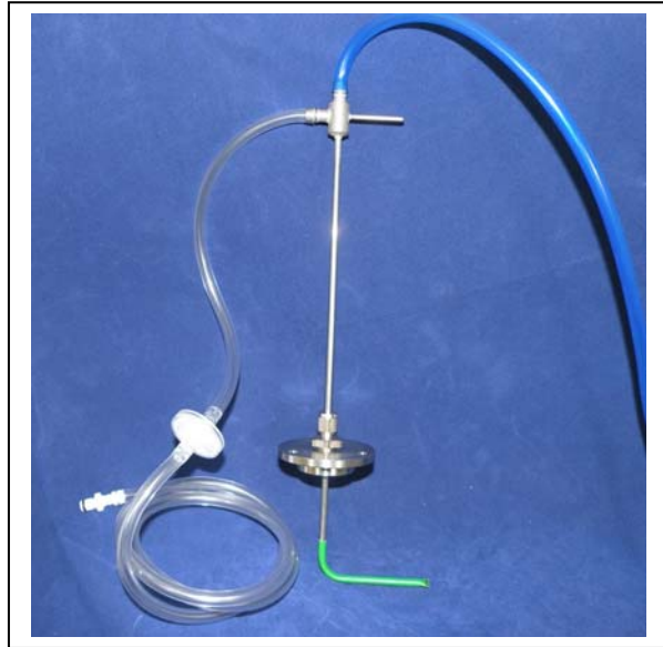
ピトー管の例 (Example of a pitot tube)
