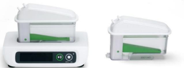
全てのBPC Goには、測定分解能の異なる2つのフローセルユニットが付属しています
