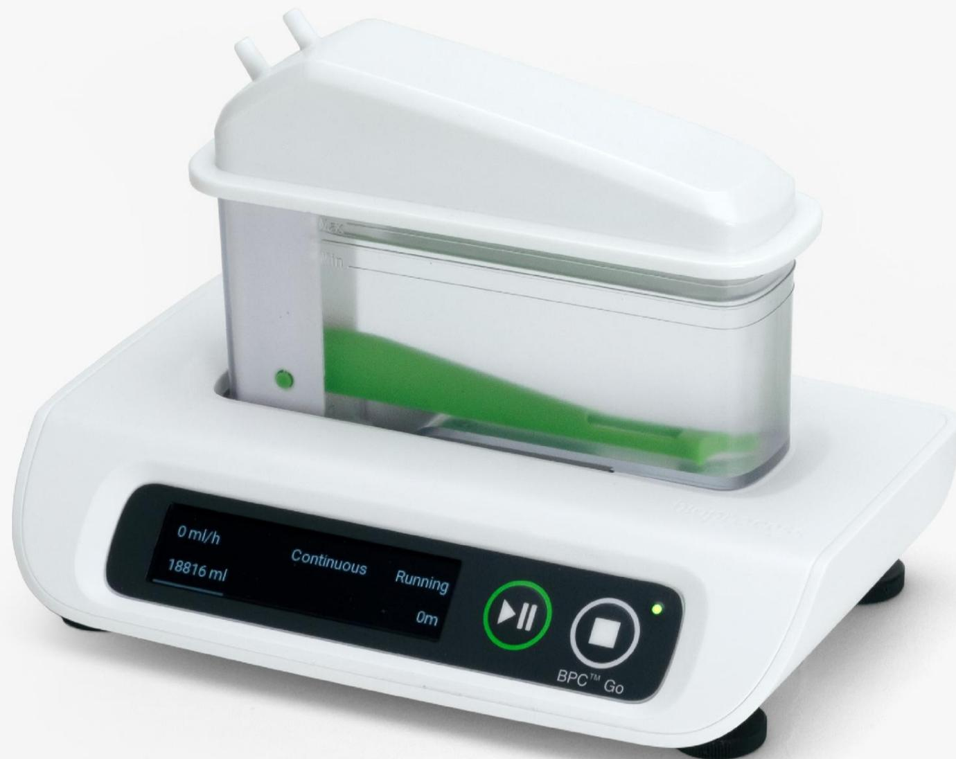
BPC Goは、任意の種類 of フローセルユニットをベースユニットに設置できる、モジュール設計を採用しています。
