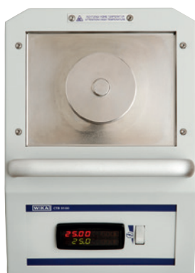
マイクロキャリブレーションバス：CTB9100-165 に ネジ切り締め込み蓋を取り付けた写真
