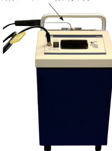
温度マルチファンクションキャリブレーターと外部アンゲル取り付け写真
