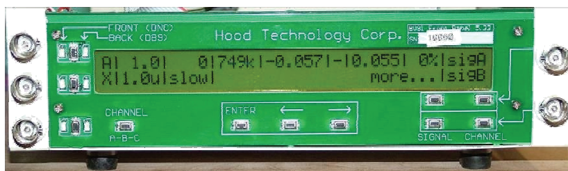
図 10: 回転翼振動センサインタフェース (Blade Vibration Sensor Interface (BVSI)) は、回転翼を通過するアナログ信号 (analog blade passage signals) を調整して、それらを正確に時間の計られたデジタル信号に変換します。
