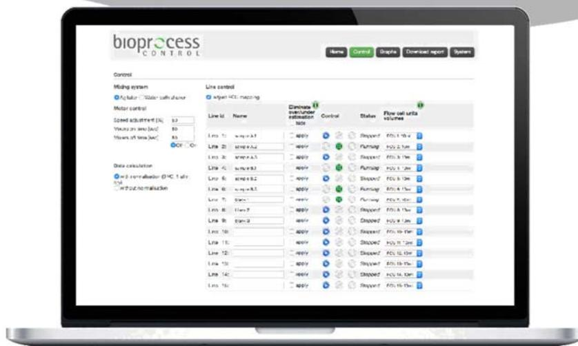
Gas Endeavourのソフトウェアのアプリケーションのグラフ機能と埋込型ウェブ・サーバーによりユーザは自分達の実験をリアルタイムでどこからでも見ることができます。ユーザは自分たちの見たい反応器だけを選択して閲覧することにより各反応器の集積されたガス容量と流動率をリアルタイムで簡単に観察することができます。
