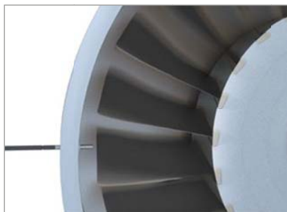
ラジアル設置:タービンでの計測
