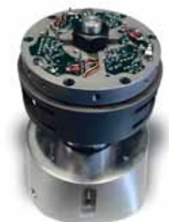
図 4: トランスミッターモジュール 内蔵型ストレインゲージバランス
