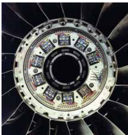
図 1: EJ200 エンジン搭載 LP コンプレッサーテスト用テレメトリー取付け
