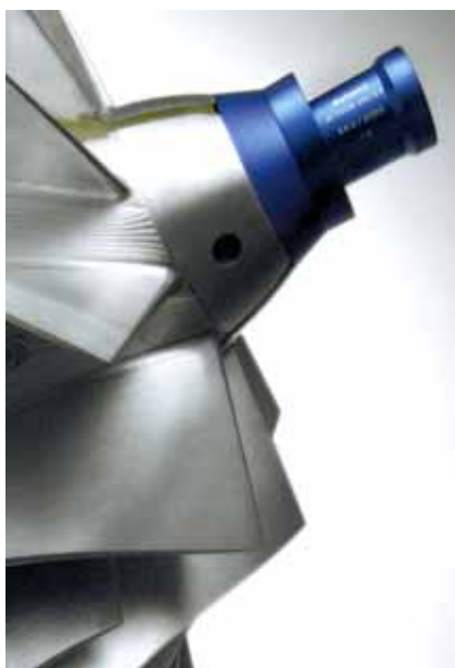
図 6: 遠心コンプレッサ試験 テレメトリーにより簡単になりました。
