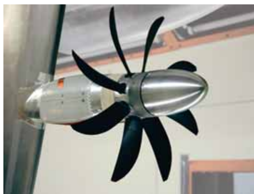
図 3: ストレインゲージバランスとテレメトリーデータ送信機の付いたプロペラモデル
