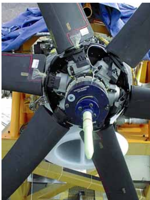
図 2: プロペラのハブに取り付けられたテレメトリー装置
