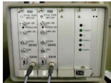
光 - 電気変換増幅器
